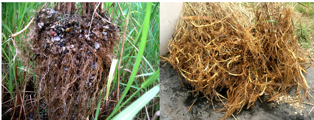
1. ábra: A nád-rizómákkal átszőtt gyökérszénés műtárgy-töltet
